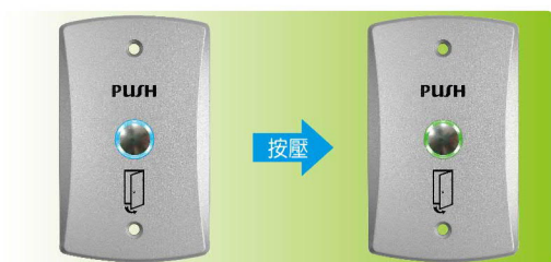
型號:PG-BUTTON-09/BG 尺寸:115(L) x 70(W) x 5(H) (通電時: 藍燈 / 按壓時: 綠燈) 接點: N.O. / N.C. / COM.
