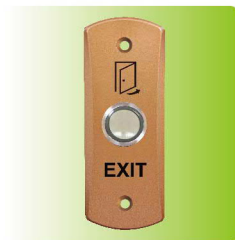
型號:PBT-08/N 尺寸:115(L) x 42(W) x 5(H) 接點: N.O. / N.C. / COM. 最低訂購量: 1,000個
